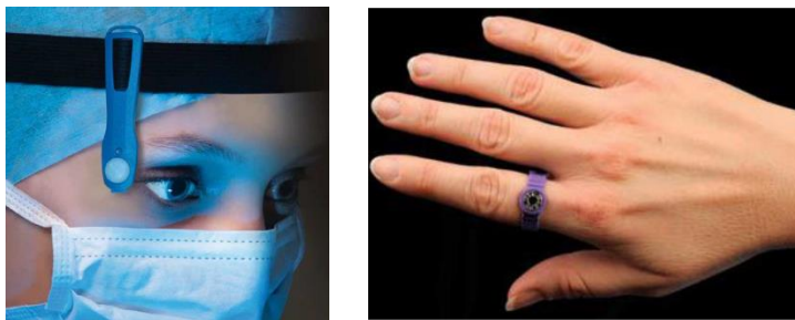
Obrázek 5. Umístění dozimetrů pro měření H_p(3) a H_p(0,07)
