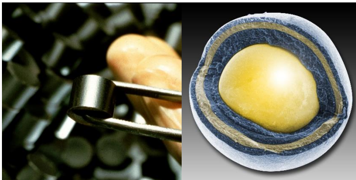
Obrázek 3. Palivová peleta \text{UO}_2 (vlevo) a částice paliva TRISO (vpravo). Jádru TRISO částice je tvořeno \text{UO}_2 , první vrstva je pyrolytický uhlík, druhá je karbid křemíku a třetí opět pyrolytický uhlík
