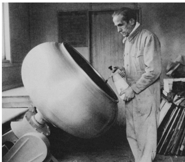
Obrázek 8: Přístroj na výrobu světlic do kulových pum (Převzato z [2])
