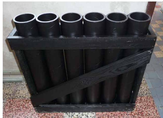
Obrázek 5: Moždíře na odpalování kulových pum o průměru 100 mm (Převzato z http://www.ohnostroje-zvonek.cz/index.php/mozdire/mozdire-4-100mm )
