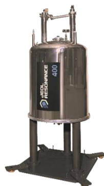
Obrázek 1. Vlevo: řez NMR spektrometrem se supravodivým magnetem: 1 – kyveta se vzorkem, 2 – NMR měřicí sonda, 3 – supravodivá solenoidní cívka, 4 – kapalné He, 5 – kapalný N 2 , 6 – kryostat (nádoba udržující nízkou teplotu); Vpravo: NMR spektrometr s celkovou výškou dva metry
