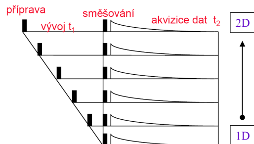
Obrázek 9. Schematický zápis sekvence při 2D-NMR experimentu
