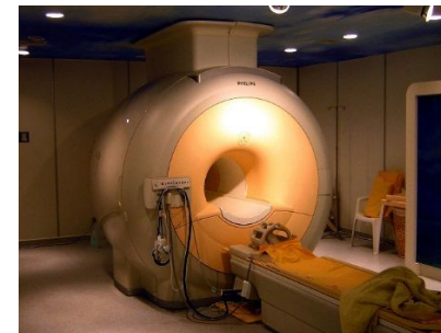
Obrázek 2. MRI přístroj o síle 3 Tesla (tj. 130 MHz pro ^1\text{H} )
