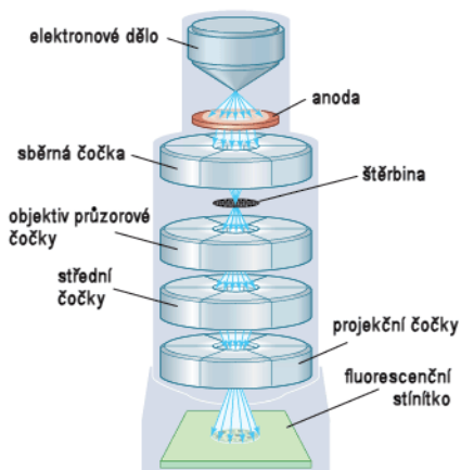
Obrázek 2: Schéma transmisního elektronového mikroskopu
